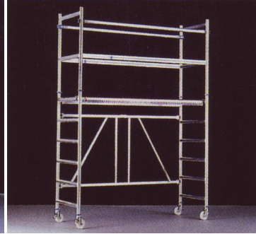
Typ KL 07-20-17 Maße: B 0,70 x L 2,10 x H 2,75 m, Arbeitsbühnenfläche B 0,60 x L 2,00 m, Gewicht 45 kg, Standhöhe 1,70 m
