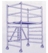
3 x Typ KL 07-20-17 best. aus 2 oder mehr Verbindungsbünnen – breitseitiger Aufbau – beliebig erweiterbar (gleicher Aufbau auch mit Typ KL 13-20-17 möglich)
