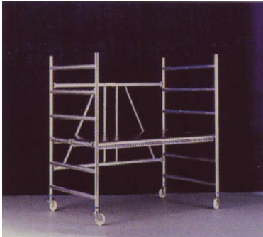
Typ KL 13-20-08 Maße: B 1,30 x L 2,10 x H 1,85 m, Arbeitsbühnenfläche B 1,20 x L 2,00 m, Gewicht 52 kg, Standhöhe 0,80 m
