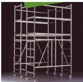
Typ KL 20-20-17 best. aus 2 Stück Typ KL 07-20-17, 1 Stück Verbindungsbühne und 4 Stück Strebe 7, Arbeitsbühnenfläche B 1,80 x L 2,00 m, Gewicht 109 kg, Standhöhe 1,70 m
