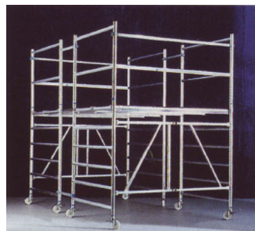
Typ KL 32-20-17 best. aus 2 Stück Typ KL 13-20-17, 1 Stück Verbindungsbühne und 4 Stück Strebe 7, Arbeitsbühnenfläche B 3,00 x L 2,00 m, Gewicht 145 kg, Standhöhe 1,70 m
