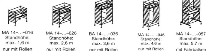
Gerüstgruppe 2: 1.5kN/m<sup>2</sup> = max. Nutzlast 360/450/522 kg Gerüstbreite 1.45 m
