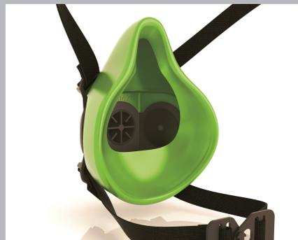
Die verstellbare Befähigung ist nicht an der weichen Gesichtsmaske, sondern direkt am äusseren Maskenkörper angebracht. Dies bietet eine bessere und beständigere Passform, höheren Komfort, sorgt für eine bessere Abdichtung und verhindert Abdrücke im Gesicht.
