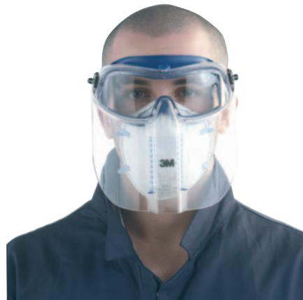
Demi-écran facial en polycarbonate avec système de ventilation réglable (position fermée ou ouverte). Système d'attache très facile (il se clipse directement sur l'attache du bandeau élastique). Offre une protection complète du visage contre les liquides tels que peinture et substances chimiques ainsi que poussière (travaux mécaniques lourds) et impacts même en milieu à très basse température. Peut être porté par-dessus un masque anti-poussières.
