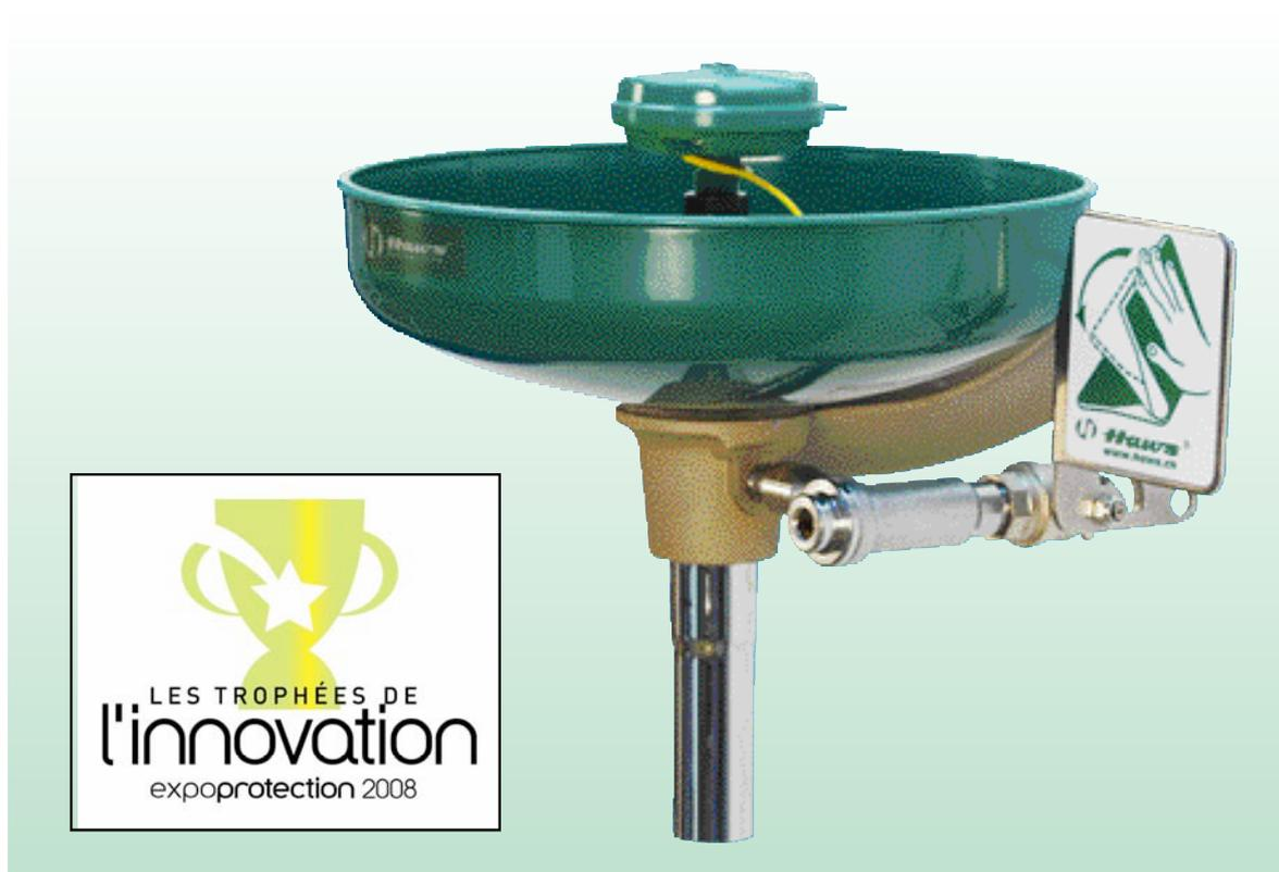
Laveur d'yeux ou de visage mural Série Axion™ à cuvette en ABS, tête d'aspersion à flux laminaire inversé en ABS traité antimicrobien SANIGUARD™ munie d'une capsule de protection et de son régulateur de pression. Livré avec le "kit interchangeable" laveur d'yeux seul et laveur d'yeux et de visage. Vanne en laiton chromé type « maintien à l'ouverture », actionnée par palette à main. Filtre à tamis inox intégré et interchangeable, fixation murale en aluminium anodisé, évacuation par tube droit
