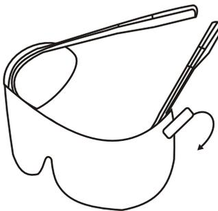
3. Entfernen Sie die zweite Deckfolie von der Aussenseite der Schutzscheibe
