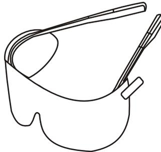
2. Klicken Sie die Schutzscheibe mit der Deckfolie nach aussen auf den Tragbügel, beginnend in der Mitte, dann die zwei äusseren Nocken.
