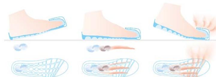
La pression du talon sur la semelle intérieure, écrasant les dômes, produit un déplacement d'air.
