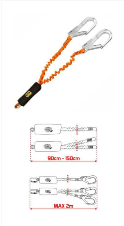
Der Falldämpfer verringert den Fangstoß und die Verletzungsgefahr im Falle eines Sturzes beim Anwender. Die beim Sturz entwickelte Energie wird durch das Aufreißen spezieller Fäden im Gurtband absorbiert.
