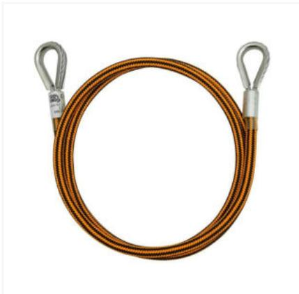
Longe de maintien au travail de longueur fixe créée avec câble d'acier galvanisé anti-coupe diamètre 6mm (133 fils) recouverte par double gaine en polyester avec diamètre extérieur de 12mm.
