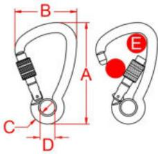
Ovaler Karabiner aus Kohlenstoffstahl mit großer Öffnung. Hoher Last von 40 kN. Ideal für Schwerlast-Anwendungen und für das Anschlagen an einer Struktur, Lifelines, usw...
