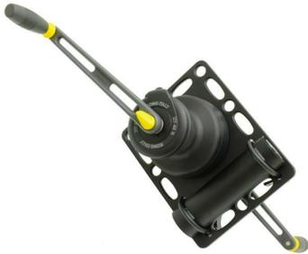
Das Set besteht aus einer *Winde\** (Winch), einer Aluminiumriggingplatte und einem Edelstahl-U-Bolzen, mit dem die Platte auf gängigste und röhrenartige Strukturen mit einem Durchmesser von 48 bis 50 mm, auf **4D Pole** sowie auf die gesamte Dreibeinserie montiert werden kann.
