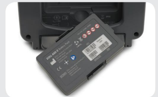
La batterie de l'AED 3 dure jusqu'à 5 ans, indique régulièrement son statut au Program Management Onboard, et est facile à évaluer à partir de l'écran tactile en mode Management.
