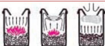
Wenn Feuer entsteht, werden die aufsteigenden Verbrennungsgase durch den Löschdeckel umgeleitet und stauen sich an der Einwurfföffnung. Die Sauerstoffzufuhr wird gestoppt, das Feuer erstickt.
