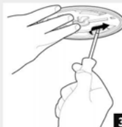
Laschen der Montageplatte Languettes de la plaque de fixation
